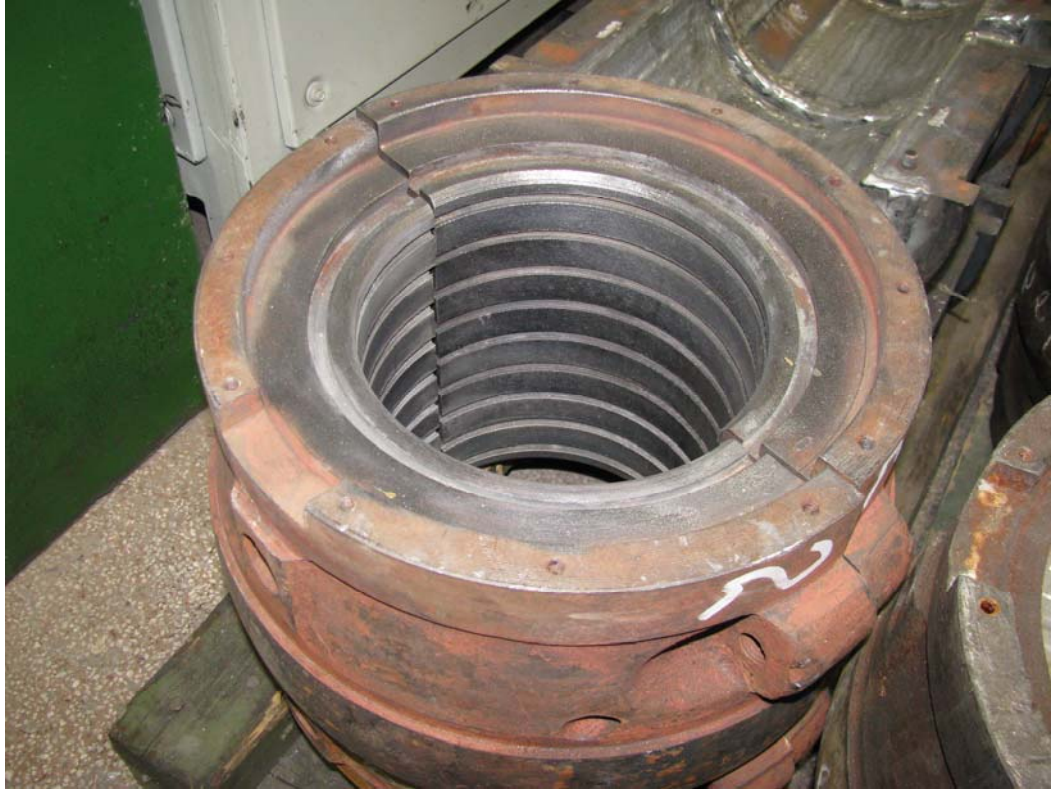
Рис. П3. Кольцо подшипника скольжения до нанесения наплавки из баббита.
