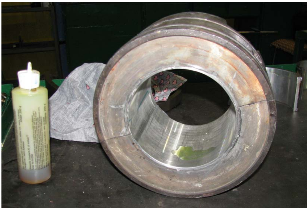
Рис. П4. Кольцо подшипника скольжения в готовом виде.
