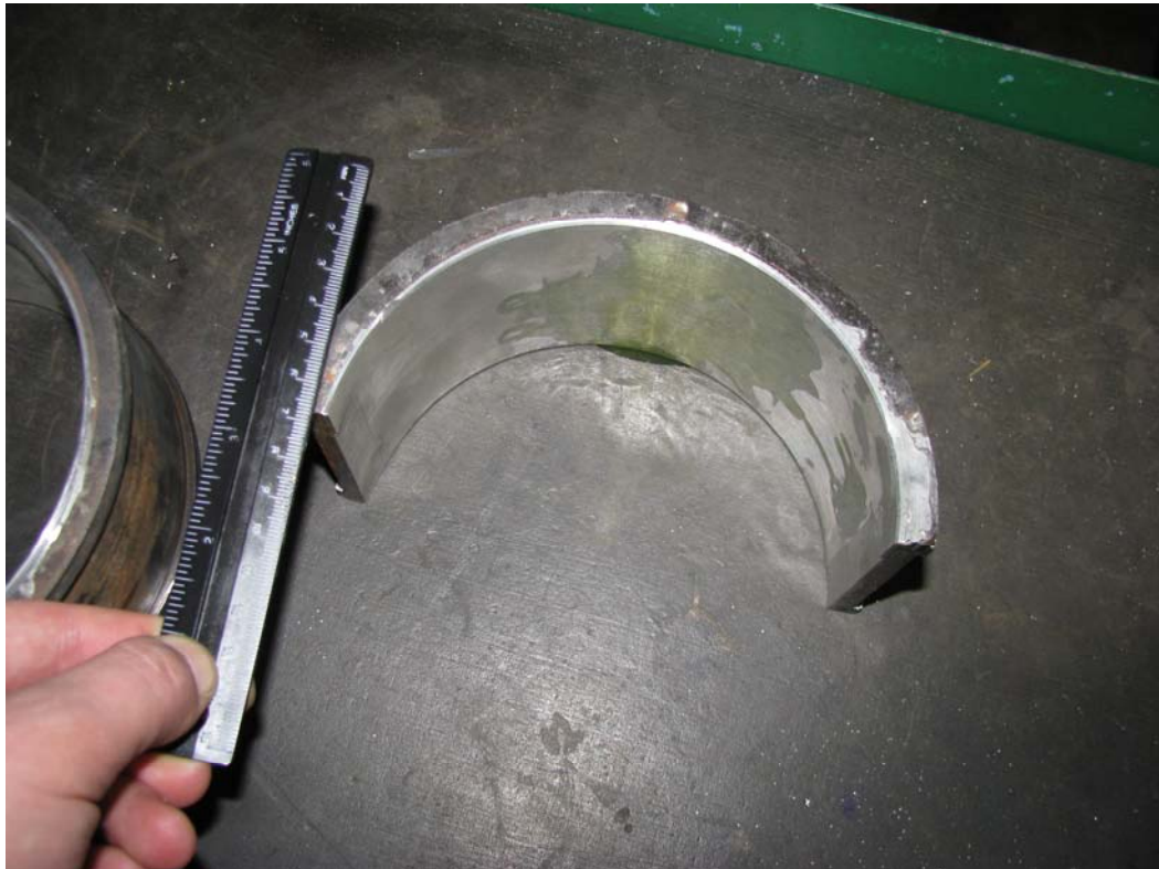
Рис.П1. Вкладыш подшипника скольжения с наплавкой из баббита.
