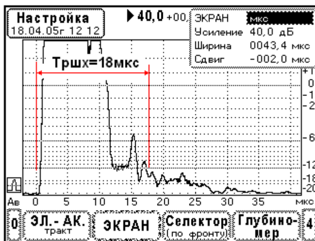
Рис. 10.6.14.1. Определение длительности РШХ. Преобразователь П121-2,5-40 0 -Ø14. Усиление 40дБ.
