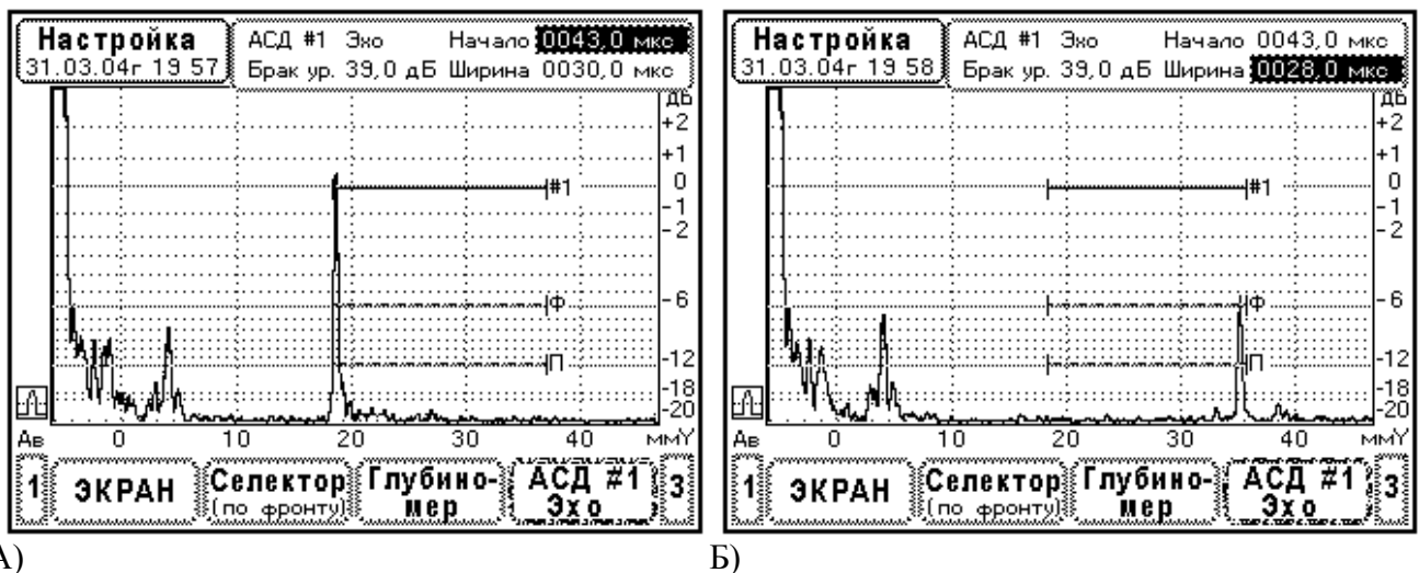
Рис. 9.4.10.3. Настройка АСД#1 по эхосигналам от зарубок. СОП толщиной 18мм. Зарубки 3,5*2,0 мм. Преобразователь П121-2,5-65 0 -Ø14.
