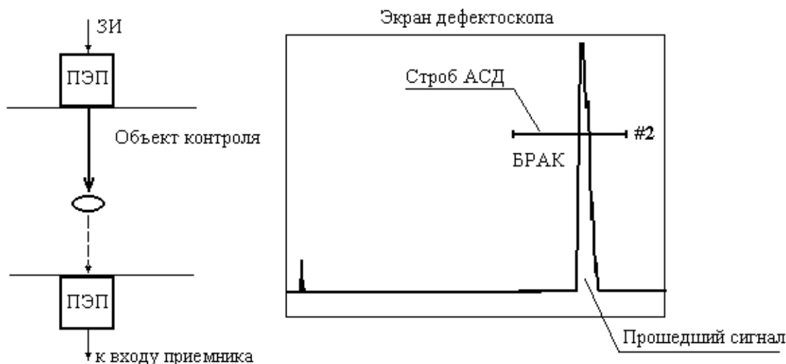
Рис. 4.13.2. Работа автоматического сигнализатора дефектов для теневого метода.
