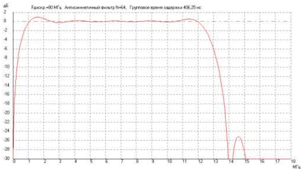
Рис. 4.4.3. Амплитудно-частотная характеристика цифрового фильтра высоких частот 0,8 – 12 МГц.
