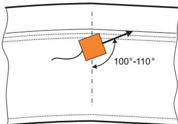
Схемы прозвучивания колес по варианту DR3.3
