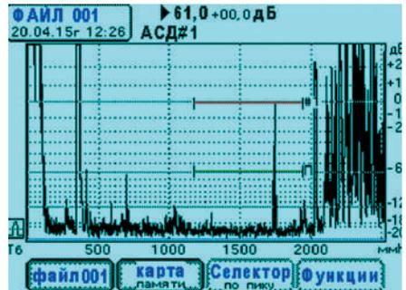
Вид экрана дефектоскопа УД9812. Нахождение дефектов.
