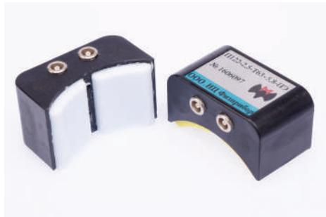
Преобразователи для контроля полиэтиленовых труб.
