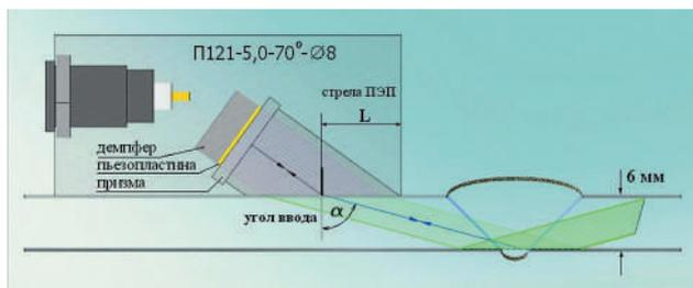
Рис.1. Прозвучивание корня сварного соединения наклонным совмещенным преобразователем
