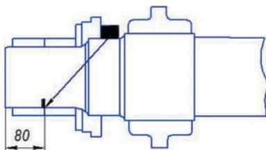
Схема установки преобразователя П121-2,5-43°-К14-ЖД на НО 1.11.002-О при проверке чувствительности по варианту BR2.
