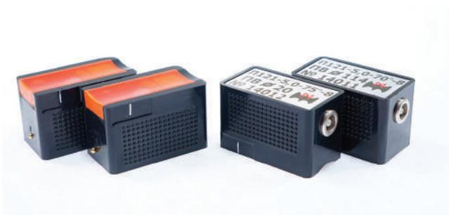
Преобразователи, притертые вдоль трубного элемента для УЗК кольцевого сварного шва.
