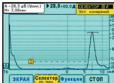
Вид экрана УД9812. Преобразователь П112-5,0-8. Эхосигнал от отверстия 2мм на глубине 8мм в образце СО-2. Разметка развертки - "ммН", глубина отражателя.
