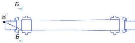
Схема установки преобразователя П121-2,5-20°-К14-ЖД (П131-2,5-0°/20°-К14-ЖД) на НО 1.11.002 – О при проверке чувствительности по варианту АР1.3.
