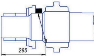
Схема установки преобразователя П121-2,5-19°-К14-ЖД на НО 1.11.002-О при проверке чувствительности по варианту ВР3.
