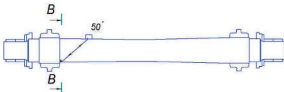
Схема установки преобразователя П121-2,5-50°-К14-ЖД на НО 1.11.002 – О при проверке чувствительности по варианту AR3.1.
