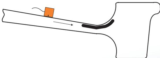
Схема прозвучивания колес по варианту WR:
