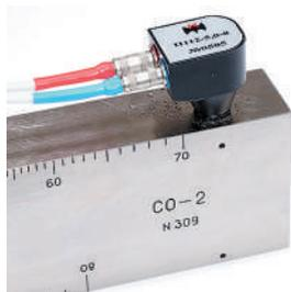
Положение преобразователя П112-5,0-8 на мере СО-2 при прозвучивании отверстия 2мм, расположенном на глубине 8мм.
