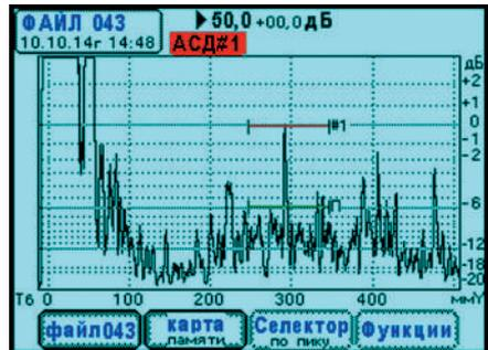
Вид экрана дефектоскопа УД9812. Нахождение дефектов.
