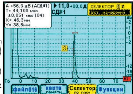
Вид экрана дефектоскопа УД9812.
