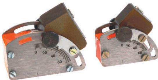
Преобразователи с изменяемым углом ввода применяются в следующих задачах ультразвукового контроля.
